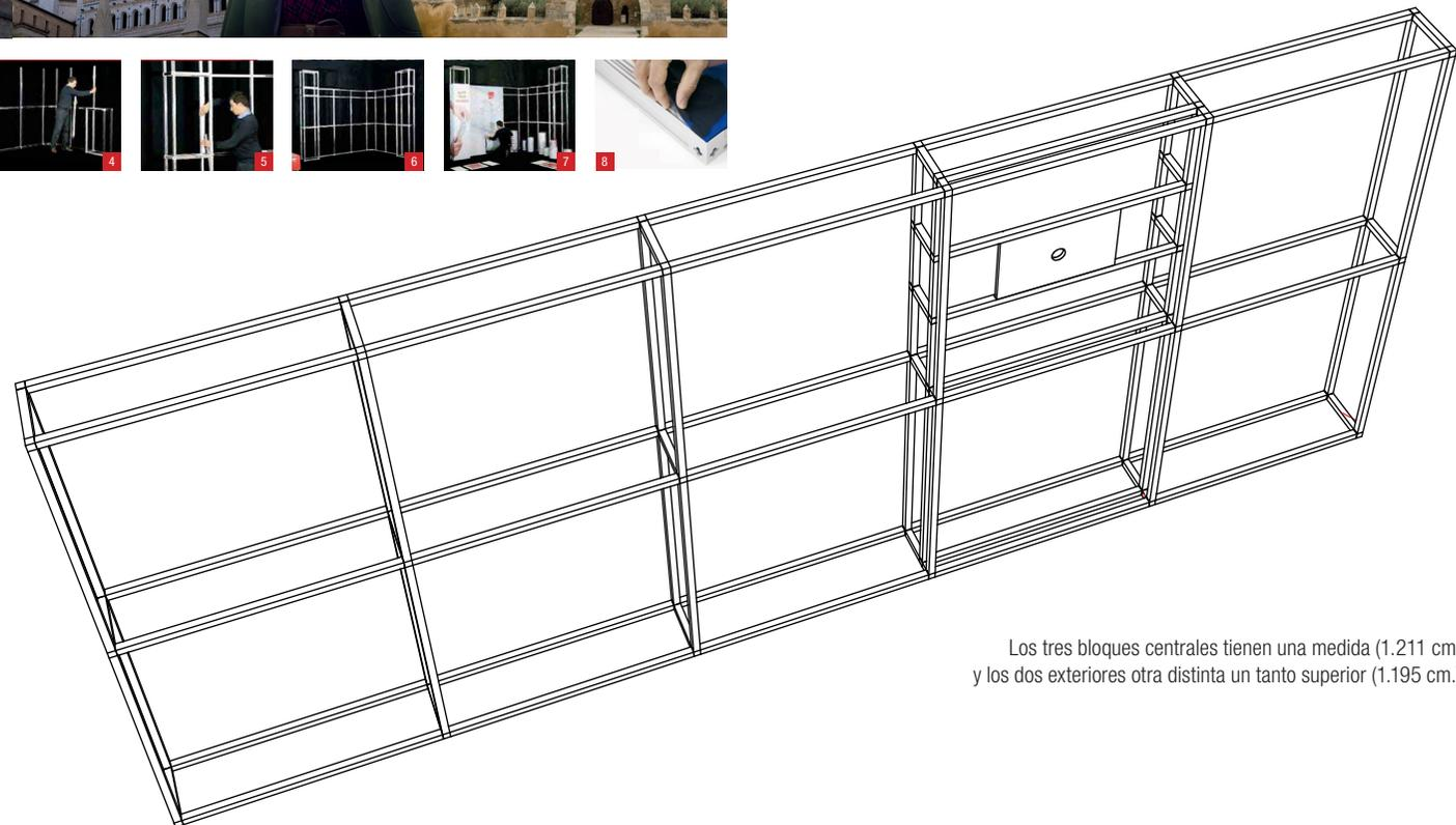
Los tres bloques centrales tienen una medida (1.211 cm.) y los dos exteriores otra distinta un tanto superior (1.195 cm.).
